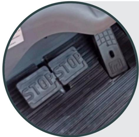
Ampio e spazioso gruppo pedaliera con **mono-pedale** (con invertitore di marcia avanti e indietro tramite pulsante al bracciolo del comando idraulico fornito) accompagnato da un grande pedale freno.
