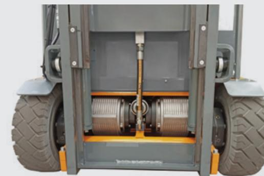
Motori con **riduttori integrati senza freni idraulici** per avere:
