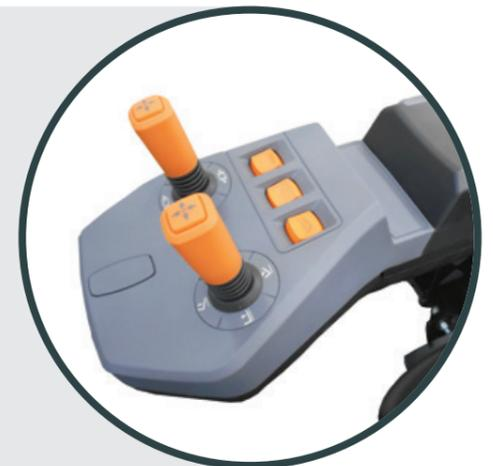
Il **comando idraulico con leve pilot** (mini-joystick) permette di guidare il carrello in modo semplice e affidabile. Agilmente accessibile e facile nel suo uso, è installato in un bracciolo ergonomico, regolabile con comando direzionale, per garantire confortevoli posizioni di guida.
