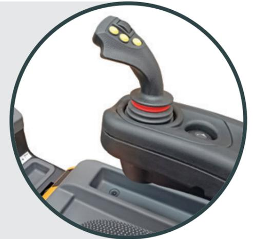
L'intuitivo ed ergonomico **comando idraulico a joystick** permette di esercitare, con un'unica leva di comando, tutte le funzioni idrauliche del carrello. Massima produttività, grazie all'utilizzo di due funzioni operative e contemporanee al gruppo di sollevamento.
