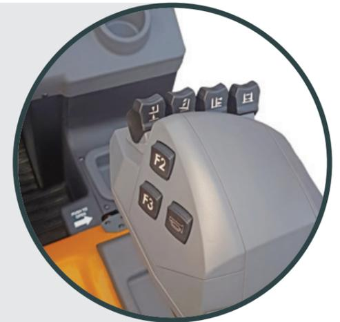
Il **comando idraulico con fingertips** (mini-leve), semplice nel suo utilizzo e facilmente accessibile, è installato in un bracciolo ergonomico, regolabile con comando direzionale. È sufficiente manovrare delicatamente il comando con fingertips per disporre di una guida e di una maneggevolezza agili, precise e sicure.
